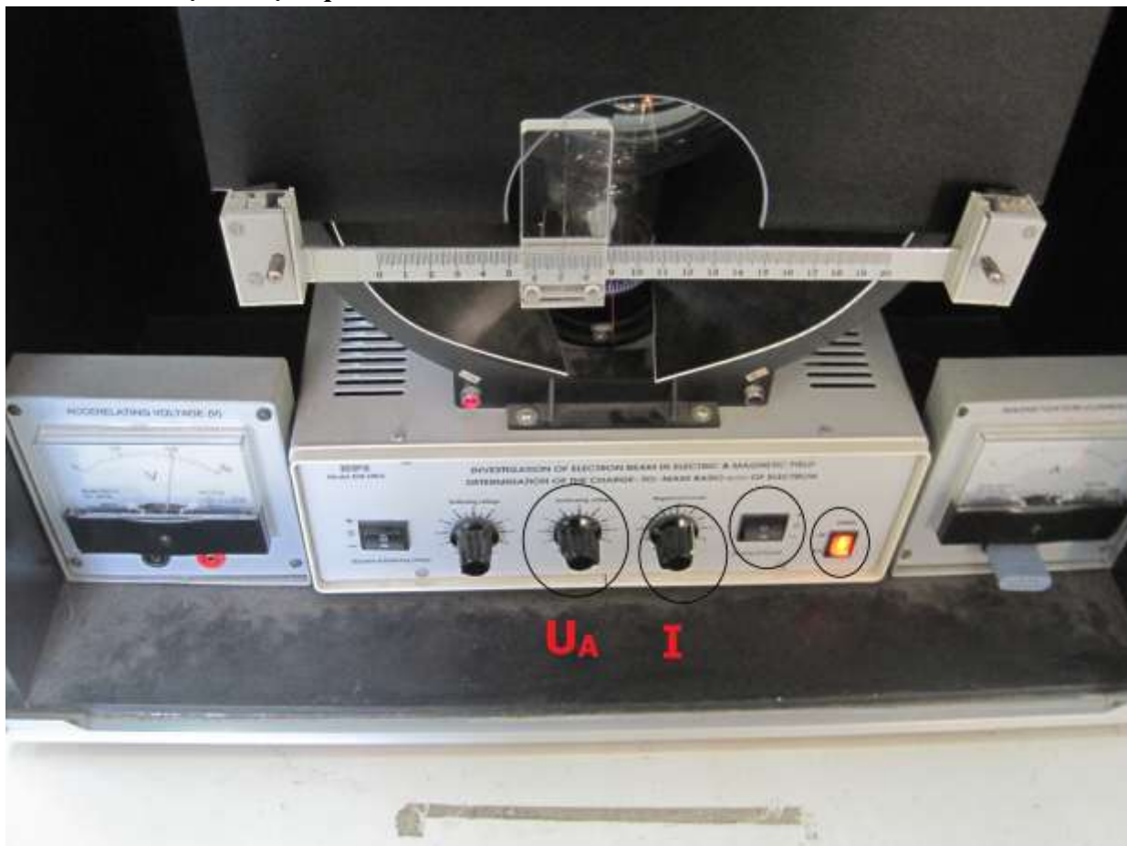
Hình 1. Thiết bị khảo sát chuyển động của electron trong từ trường
